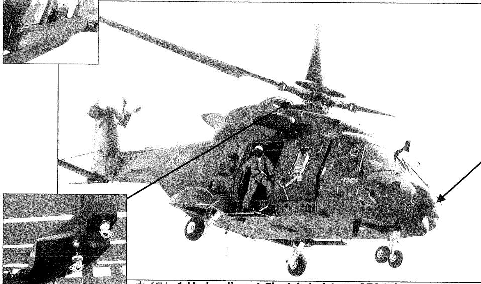
ホイスト: 1 Hydraulic + 1 Electric hoist: 270 KG, Cable length 80 m, Variable Speed
