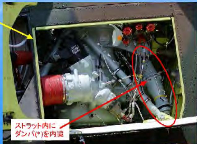
\* XOH-1(開発時)はAVRアクチュエータとしてアクティブ制御していたが、OH-1(現在)は、油圧印加・制御なしのパッシブ・ダンパーとして使用。
