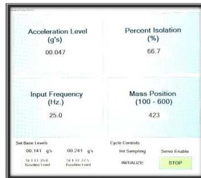
図5. 25Hz振動に対するシステムの振動低減効果
