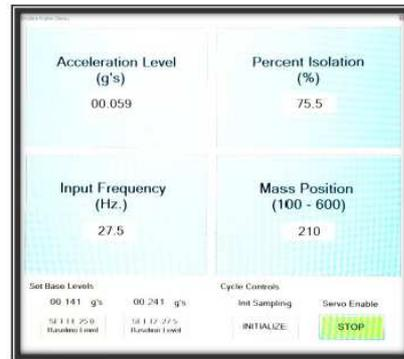
図7. 27.5Hz振動に対するシステムの振動低減効果
