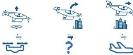
マルチコプターに類似した離着陸 遷移飛行：特異な飛行形態 固定翼航空機に類似した巡航
