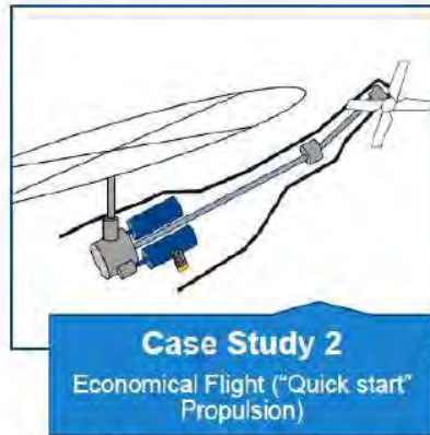
電動装置によるエンジンの クイックスタート機能 (通常単発運用とし燃費向上)
