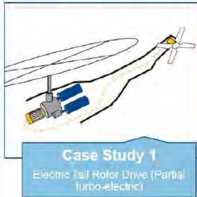
テールロータの電動化
